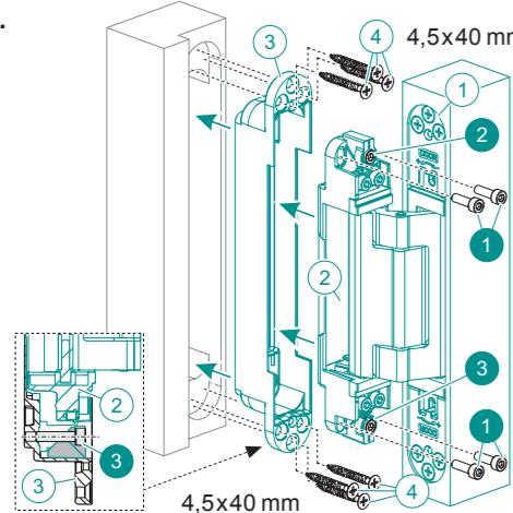
**DE** Die Aufnahme ③ in die Zarge einsetzen, die Zarge vorbohren und die Aufnahme mit den 6 Schrauben ④ befestigen.
