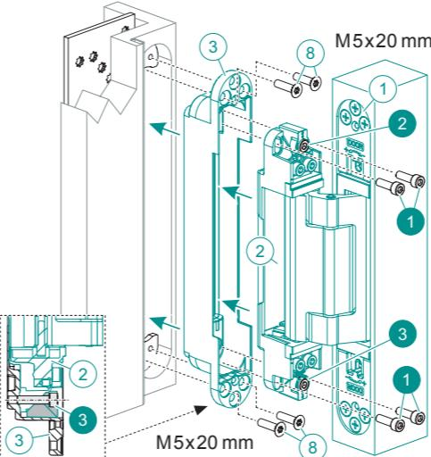
**DE** TE 640 3D FZ/1 rückseitig an der Zarge verschrauben. Je nach Zargenkonstruktion beiliegende Distanzplättchen verwenden. Die Aufnahme ③ mit den 4 Schrauben ⑧ an TE 640 3D FZ/1 befestigen (8 Nm). Das Band-Rahmenteil ② in ③ einsetzen und mit den 4 Schrauben ① befestigen (8 Nm). ② und ③ eindrehen.
