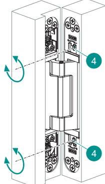
**Seitenverstellung / Side adjustment / Réglage latéral / Ajuste lateral:**
