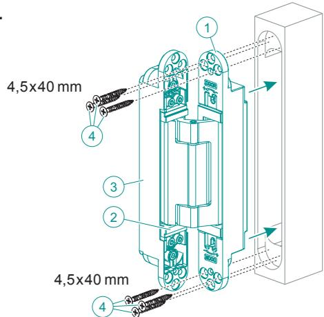
**DE** Das Band-Flügelteil ① in den Türflügel einsetzen, den Türflügel vorbohren und das Band-Flügelteil mit den 6 Schrauben ④ befestigen.
