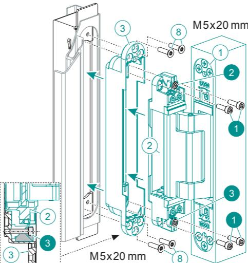
**DE** Die Stahlzarge muss mit TE 640 3D SZ ausgestattet sein (8 Nm). Die Aufnahme ③ mit den 4 Schrauben ⑧ an TE 640 3D SZ befestigen (8 Nm). Das Band-Rahmenteil ② in ③ einsetzen und mit den 4 Schrauben ① befestigen (8 Nm). ② und ③ eindrehen.
